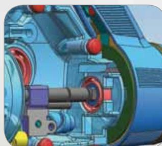
С введением в 2010 году модернизированной жесткой опоры, работа фрикциона стала намного лучше. Шарикоподшипник обеспечивает дополнительную устойчивость основного вала при колебании шпули. В катушках с задним фрикционом эту характеристику улучшили при помощи специальной втулки.
