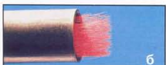
Рис. 125. Ступка и выровненный в ней пучок меховых волосков
